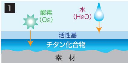
素材に密着したチタン化合物に、大気中の水分、酸素等が接触。これにより、チタン化合物の表面に活性基が発生。
