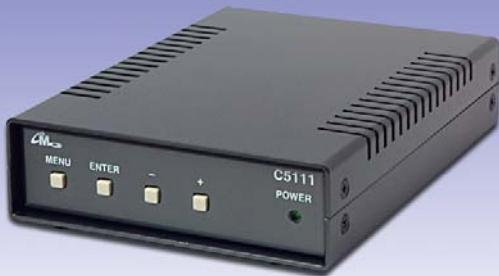
既存のシステムに本機を追加するだけで旧型モニターを新規の液晶モニターやPDPに置き換えることができます。既存システムの出力映像信号が現在市販されている液晶モニターなどに対応していない場合、モニター交換には映像信号(画面情報)を出力する制御装置の交換が必要になり多大な費用と時間を費やすことになります。そんな時(既存システムでのモニターのみの劣化・故障など)には本機を導入することにより、最小限のコストで新規の液晶モニターやPDPの使用が可能になります。
